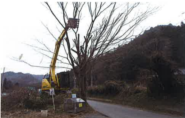
作業道作設と広葉樹伐採で威力を発揮する フェラーバンチャーザウルスロボ
