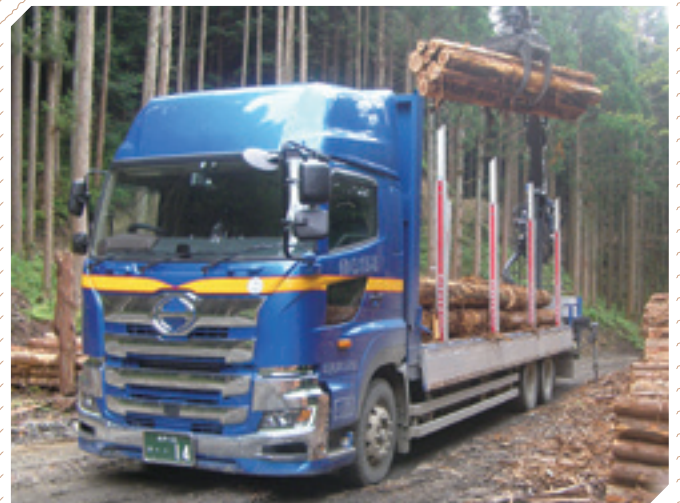
原木輸送用トラックへの積込作業
