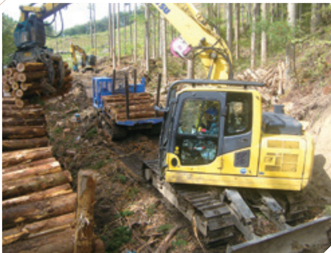
グラップルでのフォワーダへの積込作業
