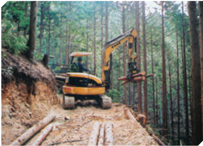
グラップルによる集材作業
