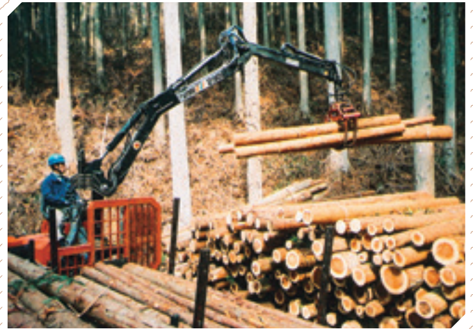
フォワーダへの積込作業
