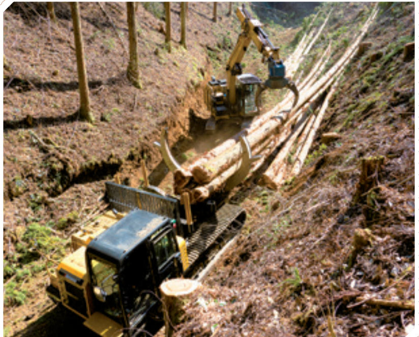
スキッダでの間伐・搬出作業
