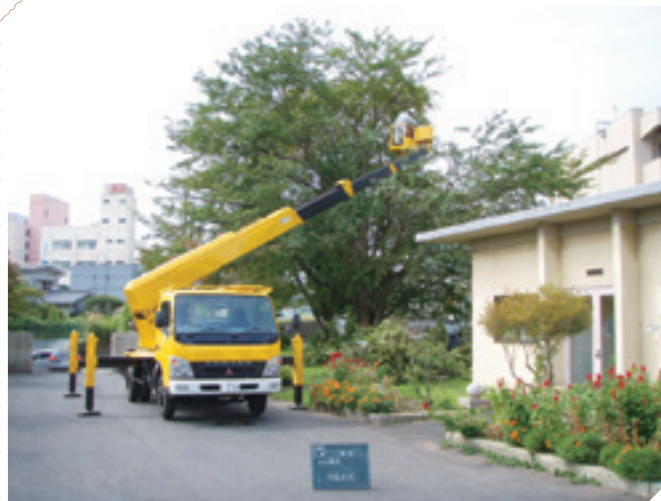
高所作業車による伐採作業
