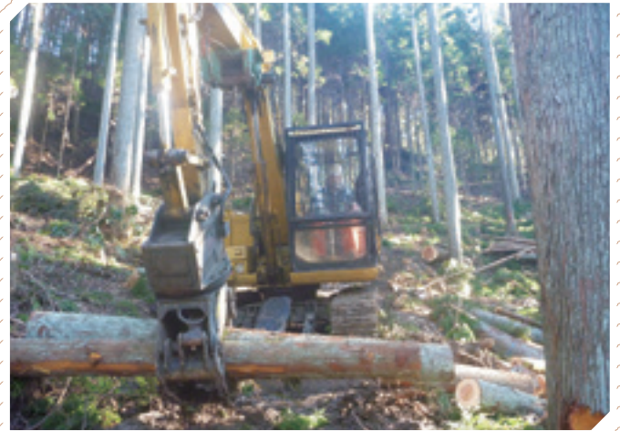
グラップルによる集材作業
