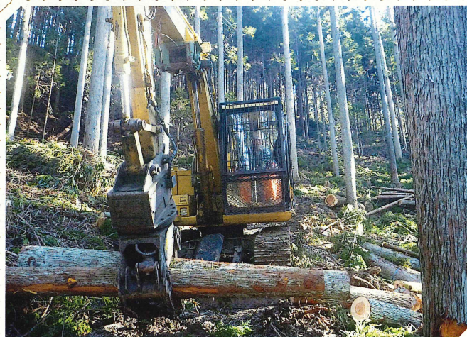
グラップルによる集材作業
