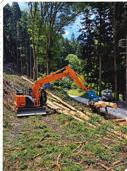
グラップルによる集材作業
