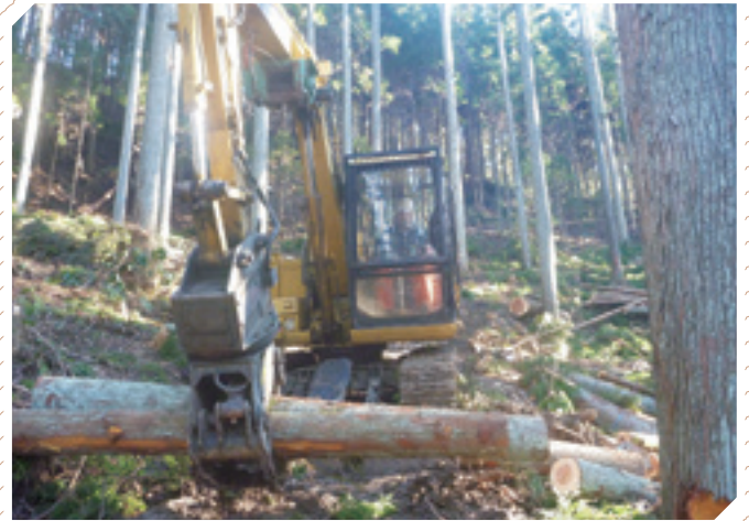
グラップルによる集材作業
