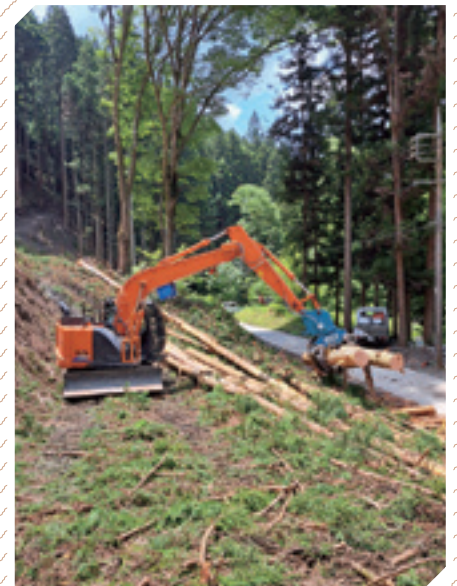
グラップルによる集材作業
