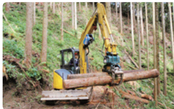
グラップルによる集材作業
