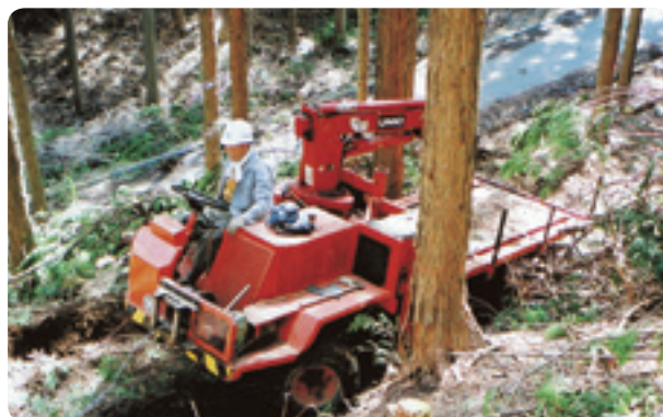
フォワーダによる間伐材の搬出
