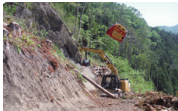
ウッドライナーによる架線集材
