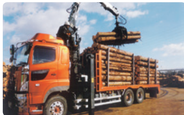
トラックによる運材作業
